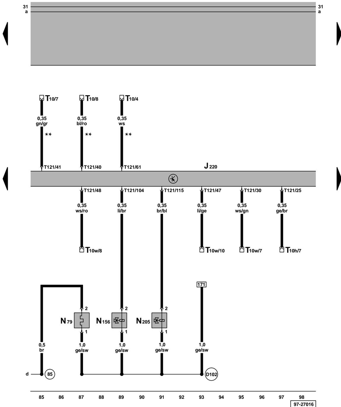
Steuergerät für Motronic, Ventil für Registersaugrohrschtaltung, Ventil für Nockenwellenverstellung, Heizwiderstand (Kurbelgehäuseentlüftung)
