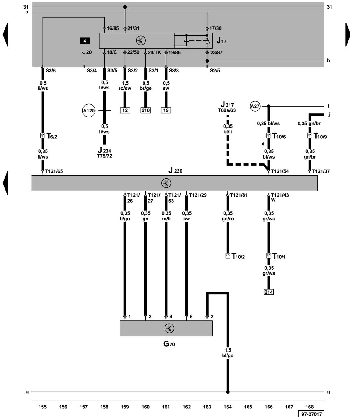
**Steuergerät für Motronic, Luftmassenmesser, Kraftstoffpumpenrelais**
