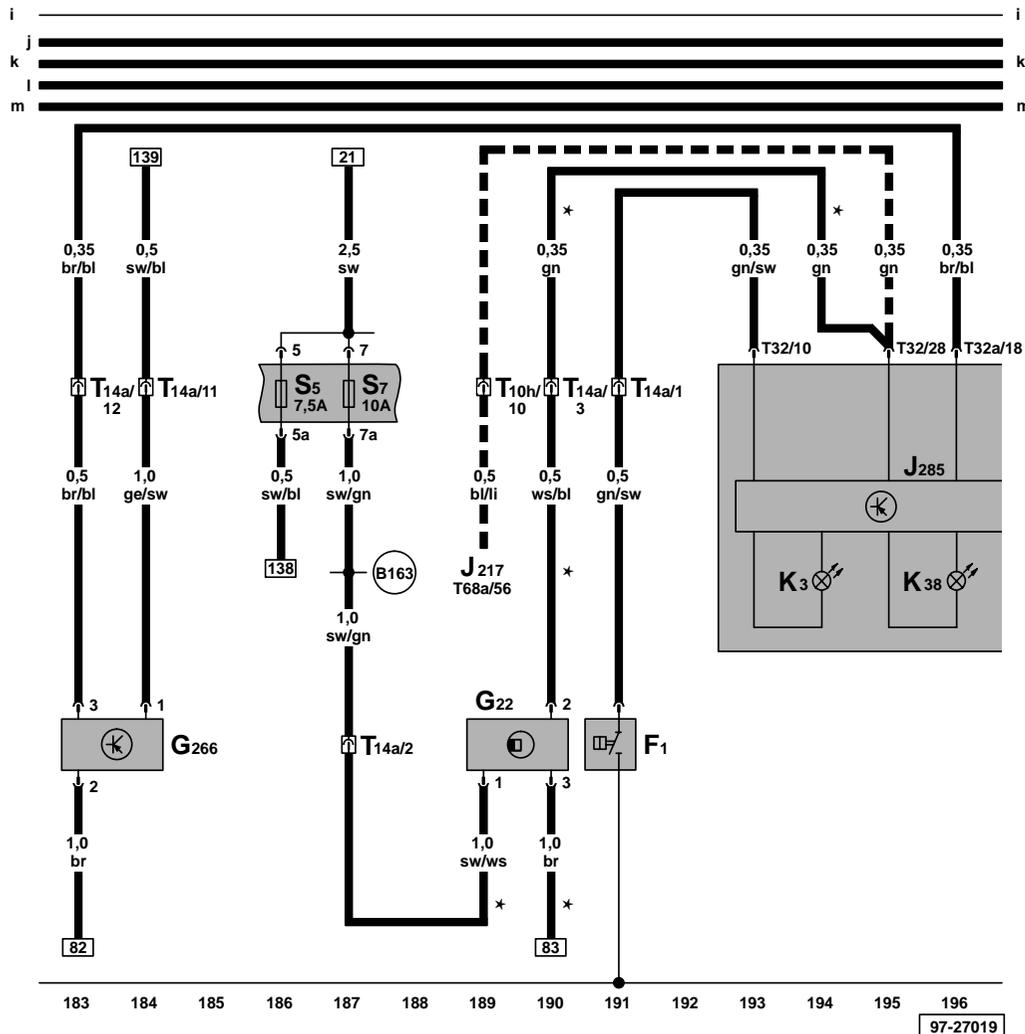
Schalttafeleinsatz, Öldruckkontrolle, Ölstand/-temperaturkontrolle, Geber für Geschwindigkeitsmesser
