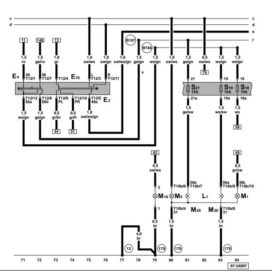
Blinkerschalter, Schalter für Handabblendung und Lichthupe, Schalter für Parklicht, Scheinwerfer vorn links, Blinklicht vorn links
