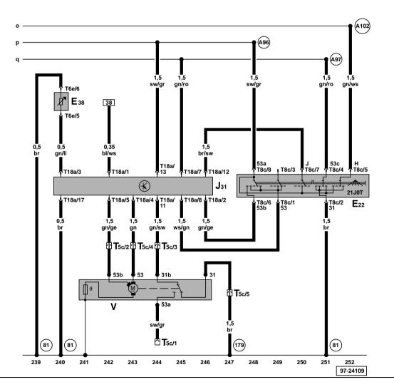
Scheibenwischerschalter für Intervallbetrieb, Scheibenwischermotor, Relais für Wasch-Wisch-Intervallautomatik
