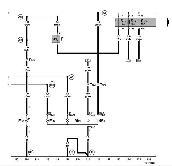
Schlußlicht rechts, Bremslicht rechts, Blinklicht hinten rechts, Rückfahrlicht rechts, Bremslichtschalter
