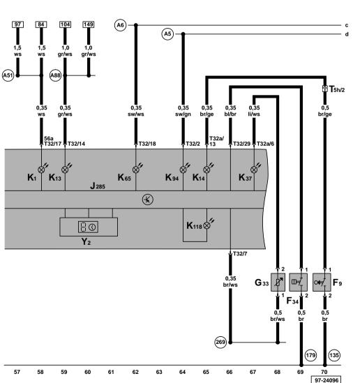
Schalttafeleinsatz, Handbremskontrolle, Warnkontakt für Bremsflüssigkeitsstand, Kontrollampen für Blinker, Kontrollampe für Fernlicht, Kontrollampe für Nebelschlußleuchte, Digitaluhr
