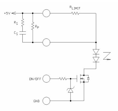
Figure 11.- Turn-on Speed-Up Circuit
