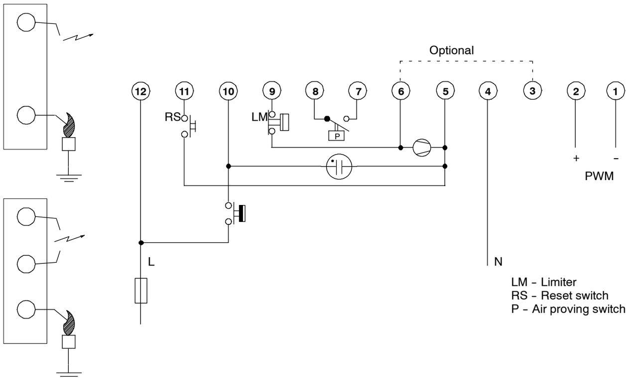
Fig. 5. Connection diagram S4565CM, DM, RM, TM <sup>1)</sup>
