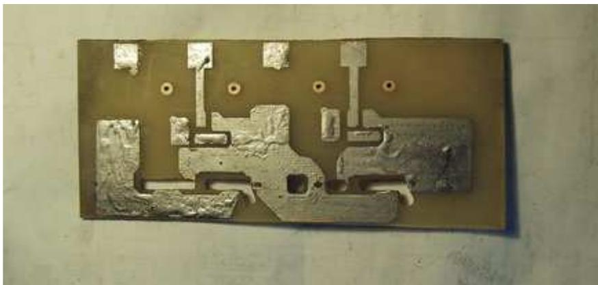
7. Устанавливаем плату на место модуля на радиаторе и сверлом 1мм прямо через плату намечаем отверстия под крепёж транзисторов, затем рассверливаем сверлом 2,3мм и нарезаем резьбу м3 (Осторожно! и свёрла и метчик легко могут сломаться! лучше пользоваться мыльным раствором а не маслом).
