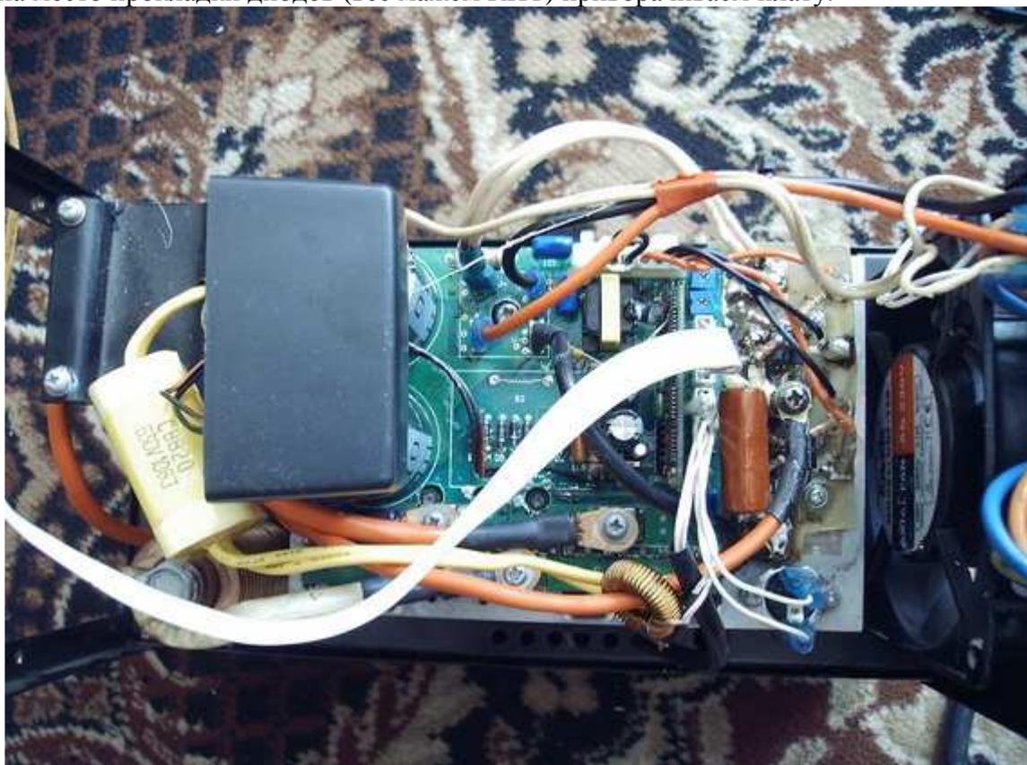
14. Проверяем прибором диоды и транзисторы на отсутствие пробоя на радиатор, если таковые имеются устраняем их.
