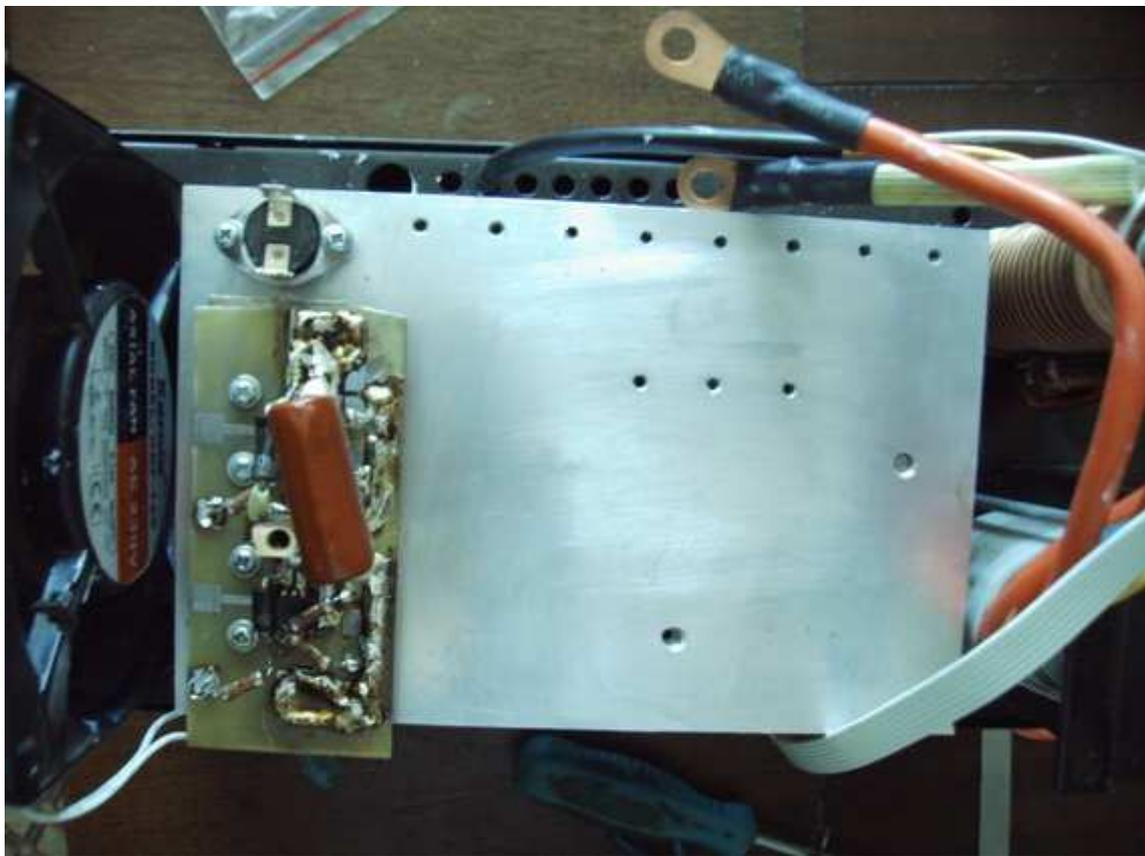
12. На плате сварочника выпаиваем 3 диода и припаиваем их в другую сторону, сверлим в плате отверстия под болты, прерванные 2 дорожки дублируем проводом.
