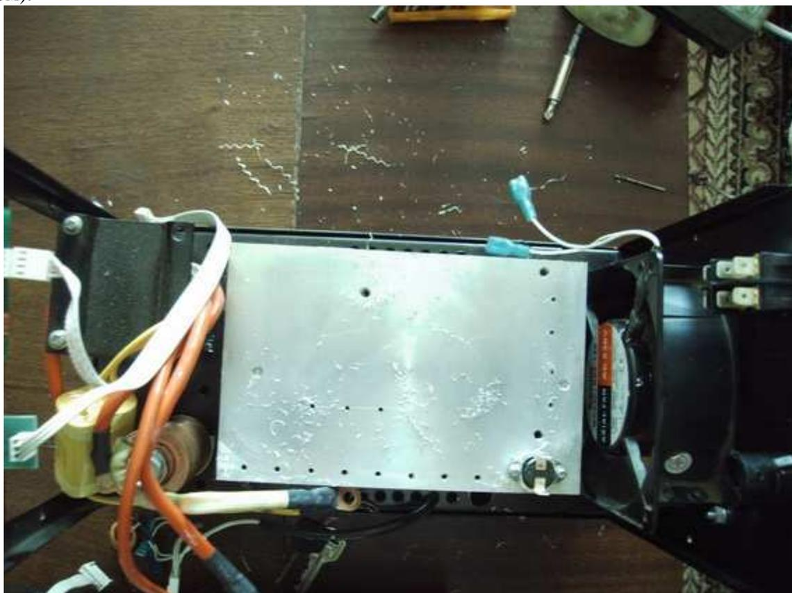
8. Вставляем в плату транзисторы и приворачиваем её, распаиваем выводы, отворачиваем, на дорожки напаиваем провод (я напаивал оплетку от тонкого экранированного провода) т.к.по ним будет идти ток до 35а.
