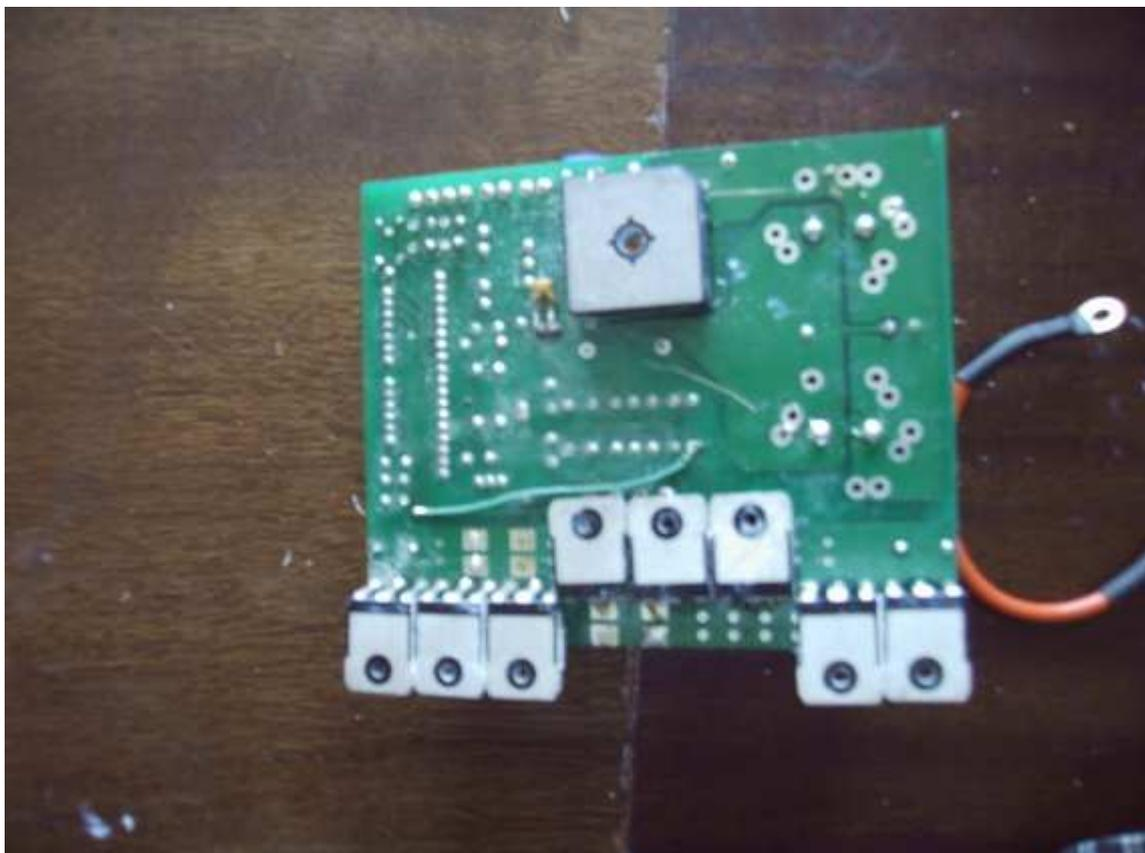
13. Ставим на место прокладки диодов (всё мажем КПП) приворачиваем плату.
