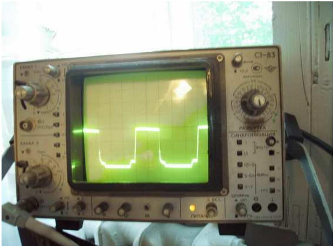
18. ИБП включаем отдельно в сеть, к выходу сварки подключаем лампу 220в75вт, +310в тоже через лампу 220в75вт, задатчик тока на передней панели - на максимум, и подаём напряжение через ЛАТР на сварочник от 0 постепенно повышая его. Нить накала лампы через которую идет +310в. должна чуть светиться. Добейтесь минимума свечения регулятором частоты (тот ,что ближе к краю платы) Контролируйте форму сигнала на средней точке транзисторов - должны быть почти
