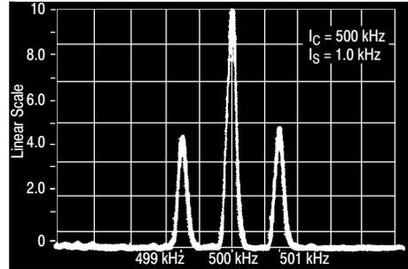
Figure 4. Amplitude-Modulation Spectrum
