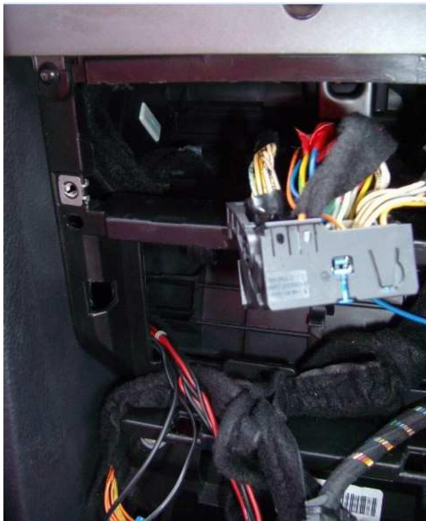
Ubicada la caja en el interior, ya es solo hacerle sitio a los nuevo cables, conectar positivo bajo llave (lo he conectado en el mechero), negativo, y a montar el clima, RT3, etc.
