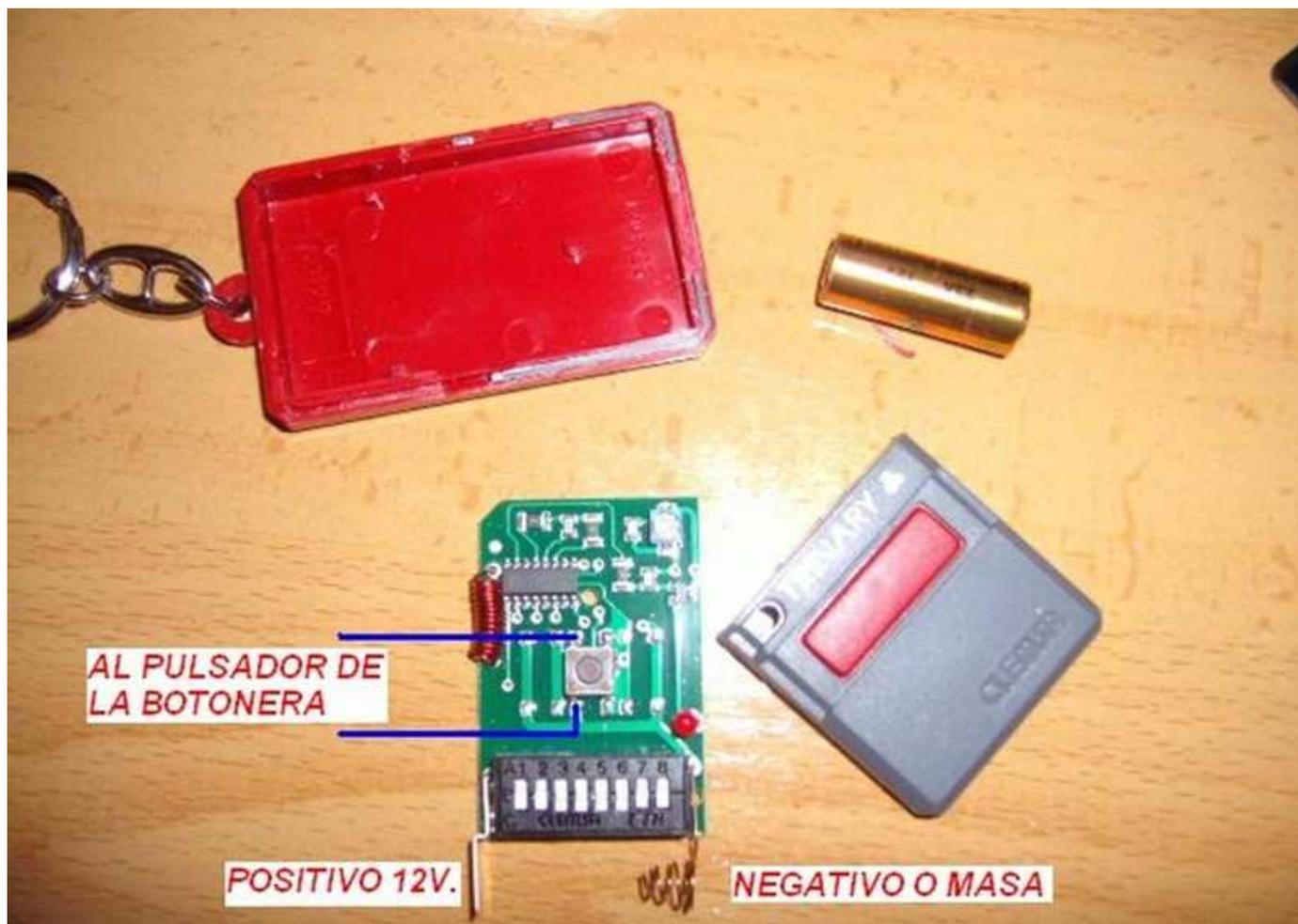
El mando del parking, el relé magnético paso a paso (biestable por pulsos), y los relés con cinta 3M a doble cara los he colocado en una caja de plástico duro de unas dimensiones aproximadas 10cm x 5cm x 3,5cm.
