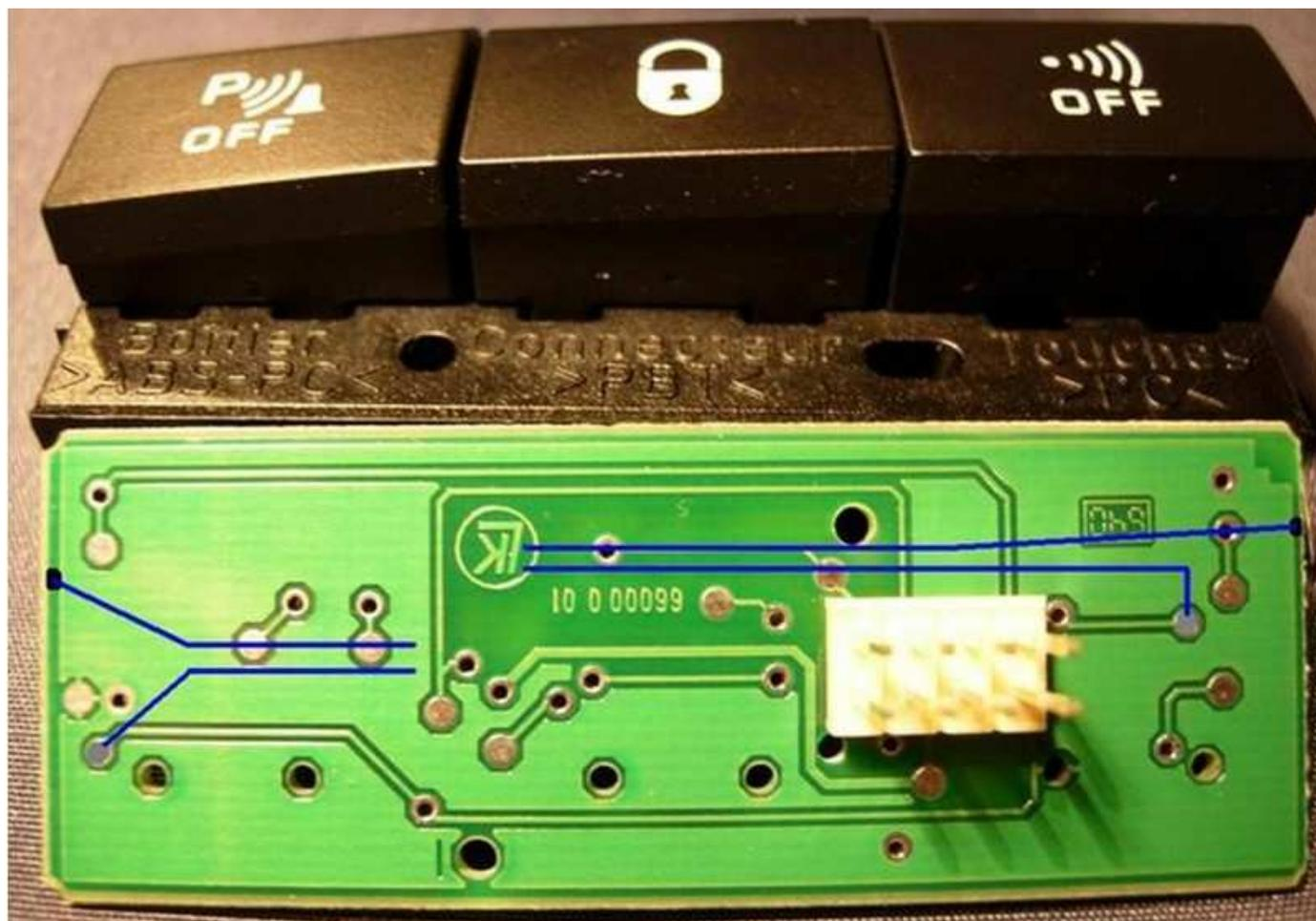
Pues llegado a este punto, estos dos cables os lo lleváis al pulsador del mando a distancia del parking y lo soldáis en paralelo al que tiene el mando. Recordar que tenéis que hacer un orificio en la carcasa azul de la botonera para sacar los cables.
