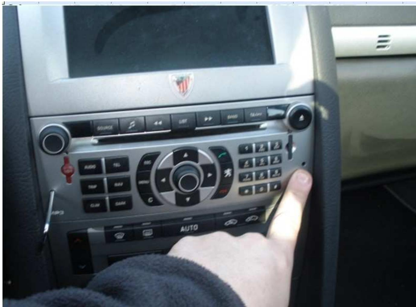
2° Guardar el RT3 en un buen sitio y procedes a sacar los mandos del AC triangulo etc. Tirando un poco hacia fuera y a la vez hacia abajo
