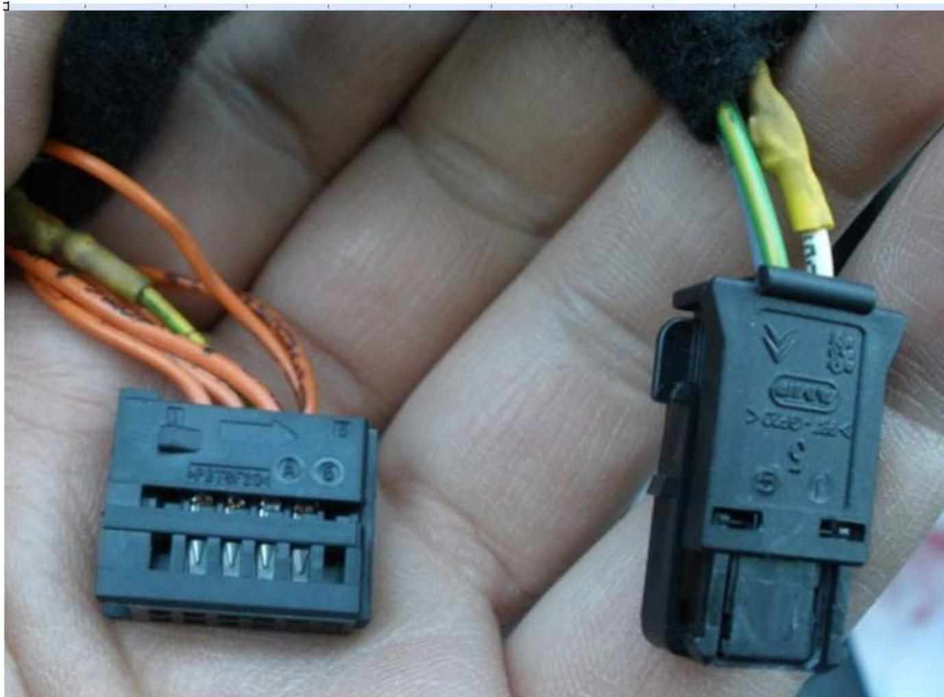
Estas son las dos clavijas que uso, La de la botonera la grande y la pequeña la del AC. En esta foto se puede ver un poco de funda termoretráctil en cada clavija, lo que he hecho es de la del AC empalmar al cable que traía el coche otro cable para llevarlo a la patilla 5 de la clavija de la botonera. Y de la botonera sacar del amarillo el negativo o 0V para el mando del garaje y de la patilla 11 el + 12 V para el mando del garaje.
