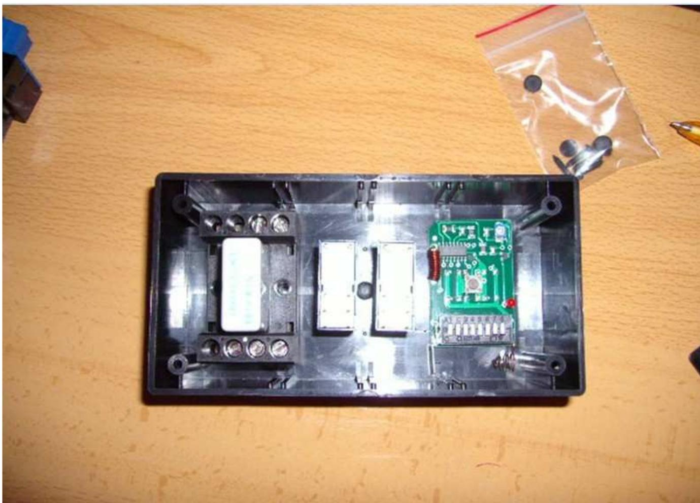
Cableamos todo conforme al esquema. El pulsador del mando es muy simple ya que proporciona alimentación directa de la pila al circuito electrónico. En la foto, se puede apreciar que los únicos contactos que "trabajan" de los cuatro que tiene, solo los dos de la izquierda que son los que hacen de interruptor. Los dos de la derecha están soldados a la placa, supongo para que no estén sueltos. A la tapa le he tenido que hacer un pequeño agujero porque es un pelin estrecha y toca el relé biestable.
