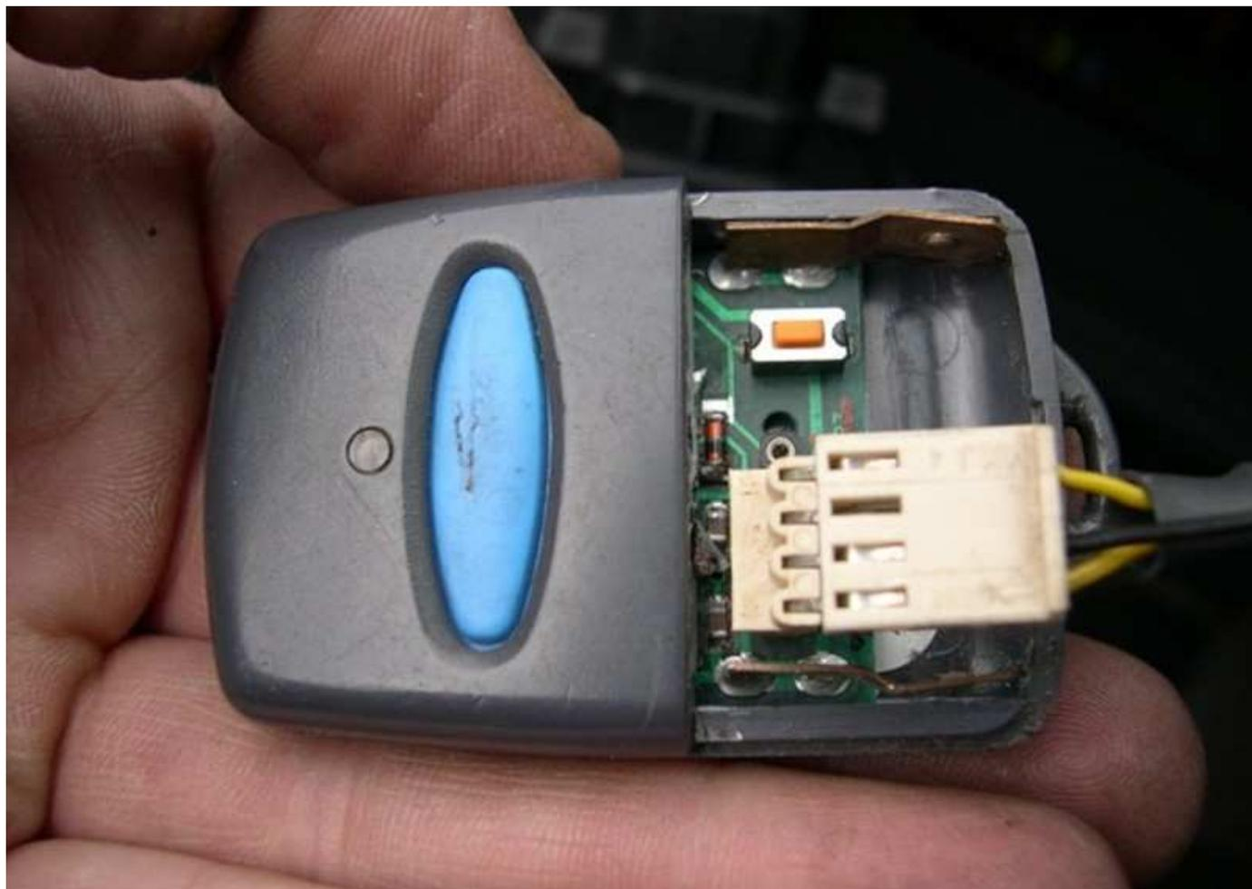
En mi caso he usado esta clavija para tener la opción de poder llevarme el mando si me hace falta. Solo uso realmente dos cables +12 V de la patilla 11 de la botonera y masa o 0 V de la patilla 10 de la botonera. Lo que pasa es que a lado del mando en el cable he hecho un empalme para simular que el botón del mando esta pulsado y así al alimentarlo es como dar al botón del mando.
