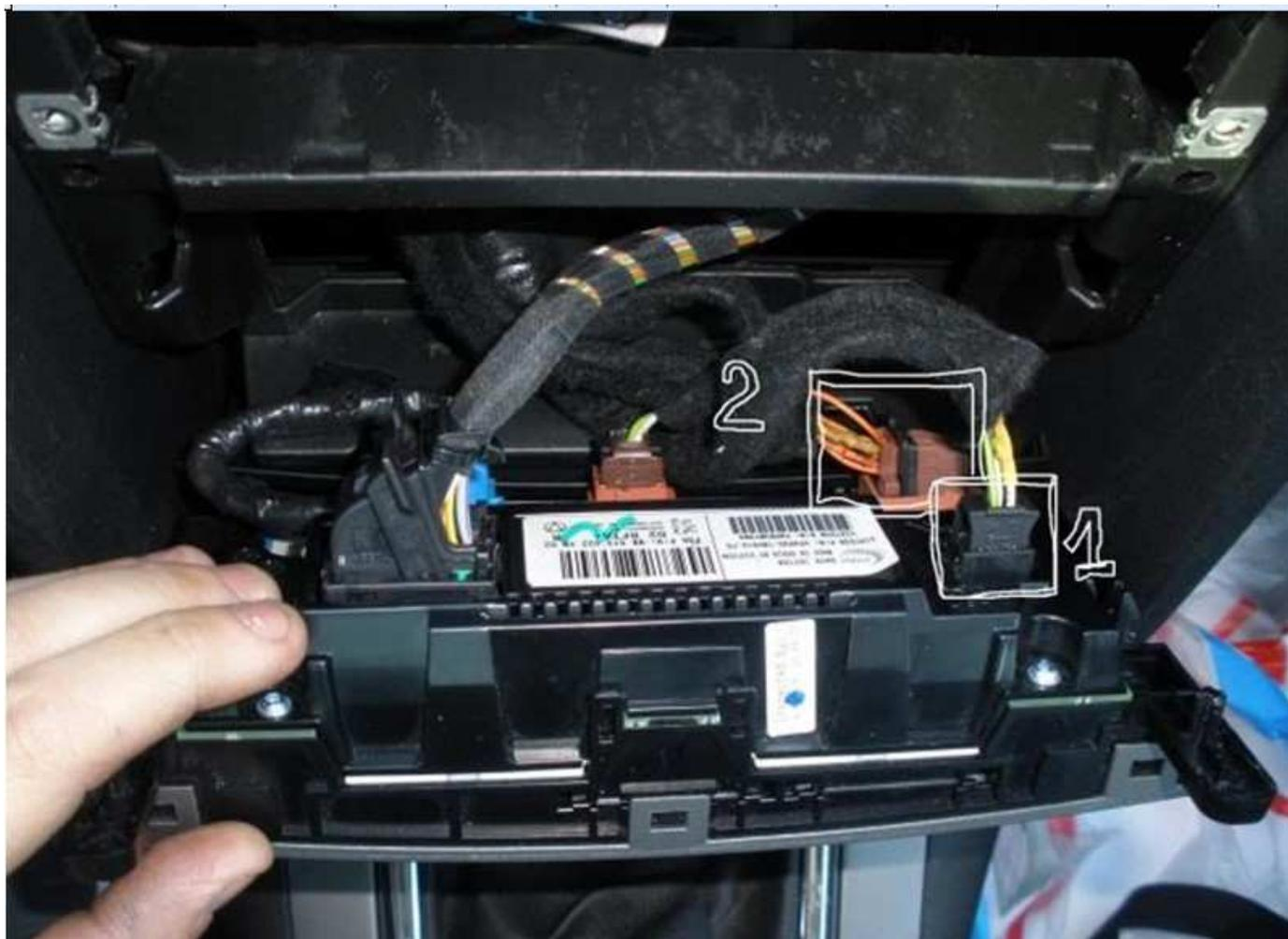
El numero 1 es la clavija de alimentación al modulo del Climatizador o AC tiene 6 patillas pero solo usa 4 (La 1= +12 V , la 4= Masa o 0 V, la 3 y 6 comunicación con la BSI 1) De la patilla 1 cojemos la alimentación (12 V) para llevarlo a la botonera.
