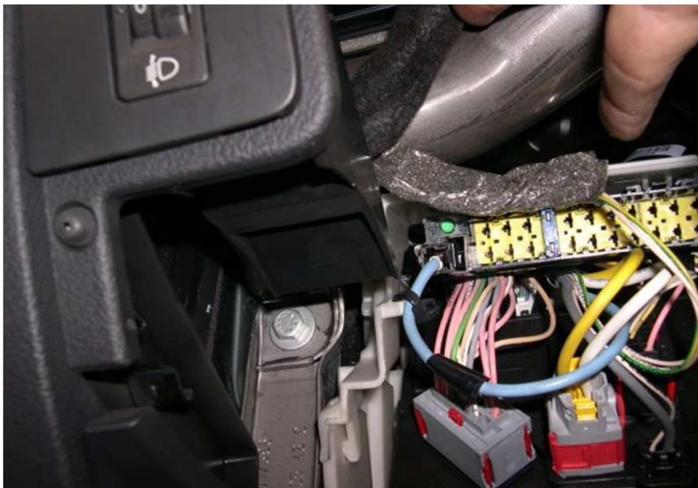
Aquí ya esta montado y puesto en su sitio el mando. Sacarlo es simplemente tirar un poco del cable hacia dentro de la caja de fusibles y tendremos el mando del garaje para poderlo llevar a donde queramos.
