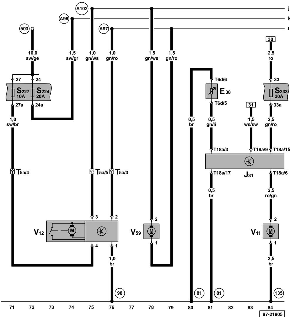
**Motor für Heckscheibenwischer, Front- und Heckscheibenwaschpumpe, Pumpe für Scheinwerfer-Reinigungsanlage**
