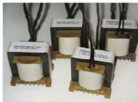
Fot. 2 Gotowe transformatory i dławiki
