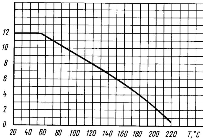
Характеристика зависимости предельно допустимой мощности, рассеиваемой анодом, от температуры окружающей среды при температуре баллона ( $T_b$ ) равной 260 °C
