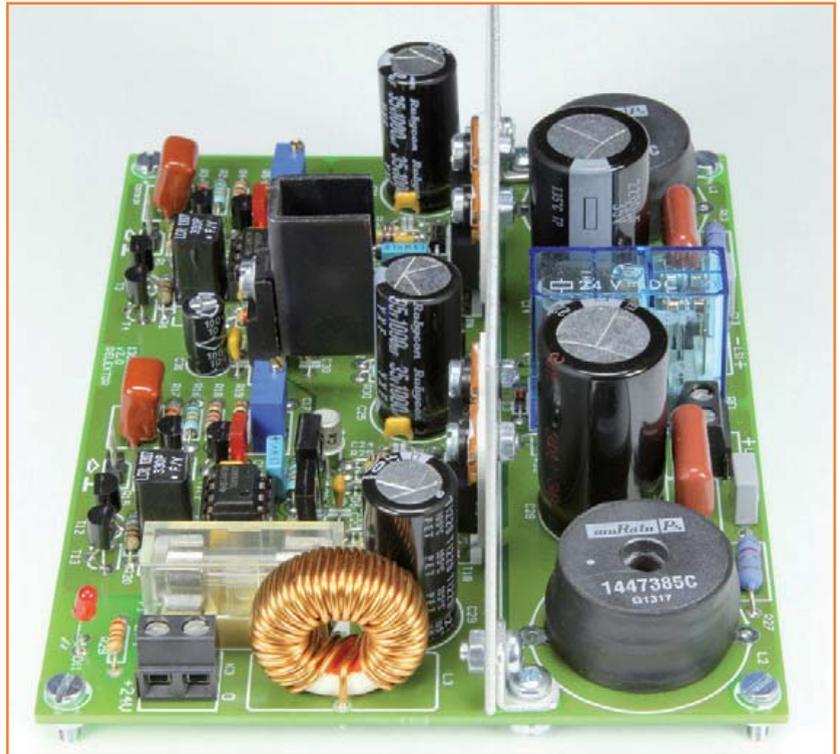
Bild 3. Im Foto, aufgenommen von der Seite, sind die Bauelemente links und rechts der Kühlplatte sichtbar.
