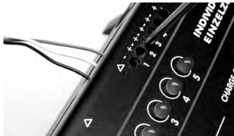
Le chargeur Lipomat dispose d'un second branchement alternatif pour cordon-capteur de charge ne correspondant pas à la norme robbe.
