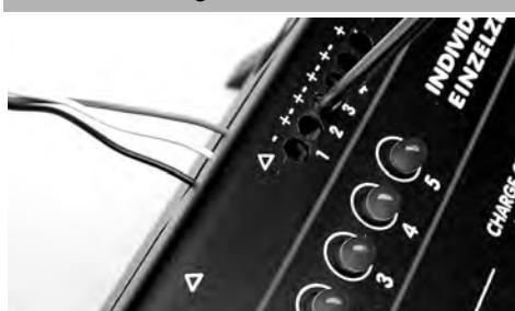
Il caricabatterie Lipomat dispone di una seconda presa di collegamento alternativa per l'allacciamento di cavi-sensori differenti da quelli robbe. In tale presa è possibile collegare il proprio tipo di cavo attraverso il collegamento a vite appositamente predisposto. Il collegamento delle batterie deve avvenire nella stessa modalità vista in precedenza. Anche in questo caso occorre collegare il polo negativo comune (nero) all'uscita nr. 1 contrassegnata dalla freccia.
