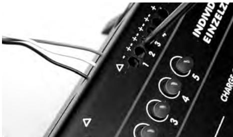
Das Lipomat Ladegerät besitzt einen zweiten, alternativen Anschluss von Voltage-Sensorkabeln welche nicht der robbe Norm entsprechen. Hier kann über die Schraub-Klemmvorrichtung ein eigenes Streckensystem angebracht werden. Die Verschaltung des Akkus muss in der gleichen Weise erfolgen. Auch hier muss der gemeinsame Minuspol (schwarz) an den mit dem Pfeil gekennzeichneten Anschluss 1 angeschlossen werden.
