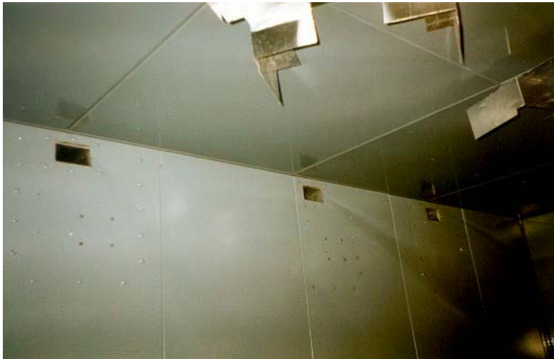
9. ábra: Tápvonal becsatolások a szárítókamrába
