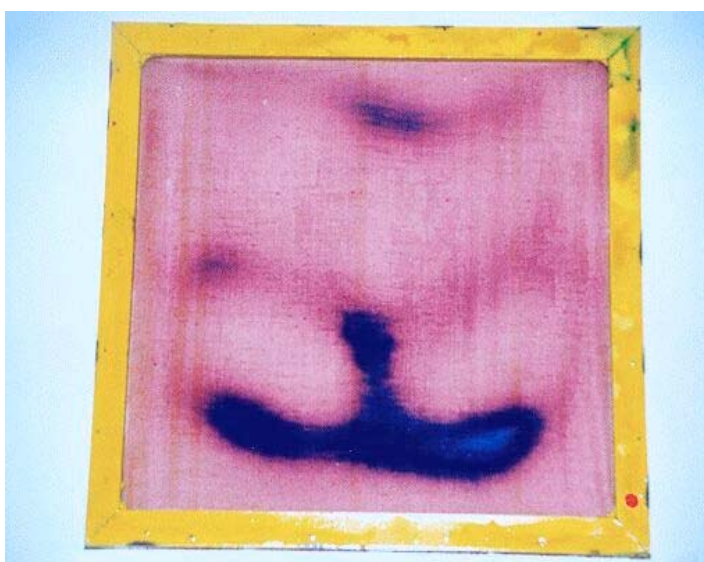
21. ábra: Az indikátor-lap elszíneződése az energia-maximumoknál z = 2 cm mérési magasságnál
