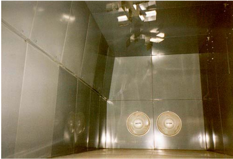
8. ábra: A mikrohullámú szárító kamra reflexiókkal
