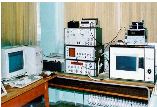
18. ábra: A multimódusú jelleg mérési összeállítása
