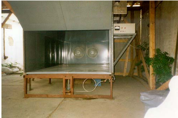
12. ábra: A szárítókamra berakodó nyílása és a súlymérés hidraulikája
