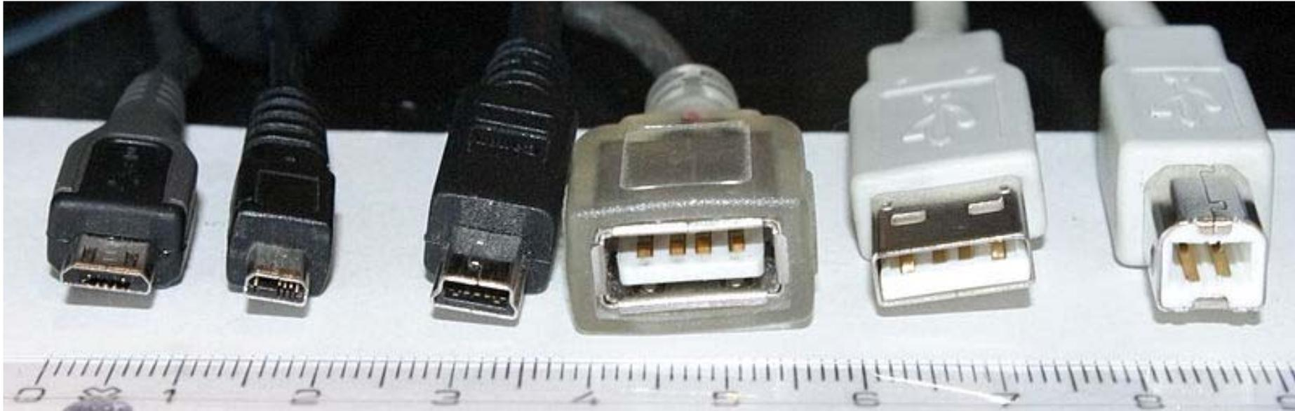
Drucker und Scanner können nicht direkt angeschlossen werden und besitzen eine USB-B-Buchse und benötigen ein Kabel mit USB-A-Stecker an der PC-Seite und USB-B-Stecker an der anderen (rechts). Geräte mit USB-B-Buchse sind immer ein Slave, was durch den Buchstaben B kenntlich gemacht wird. Bei der USB-B-Steckverbindung liegen die 4 Leitungen paarweise in zwei Ebenen übereinander. Eine Vertauschung beider Stecker ist also ausgeschlossen.
