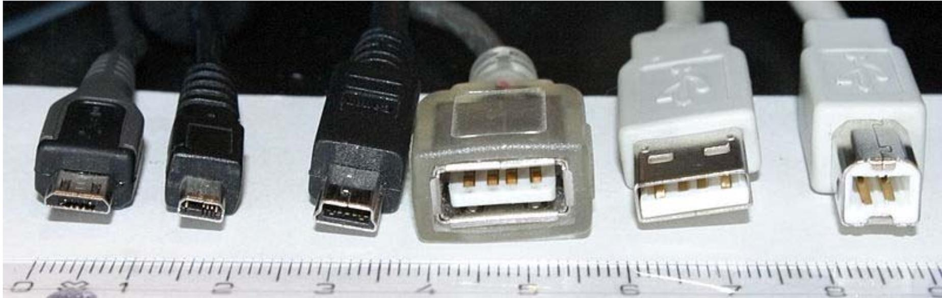
Am bekanntesten ist die USB-A-Steckverbindung. Sie ist als Buchse (Bildmitte als Buchse eines Verlängerungskabels) an jedem PC und Laptop zu finden und sie ist auch immer der Master. Den entsprechenden Stecker (2. von rechts) haben die allermeisten Slaves, wenn sie direkt angesteckt werden können. Bei dieser Verbindung liegen die Anschlüsse +5V, D-, D+ und Minus nebeneinander.
