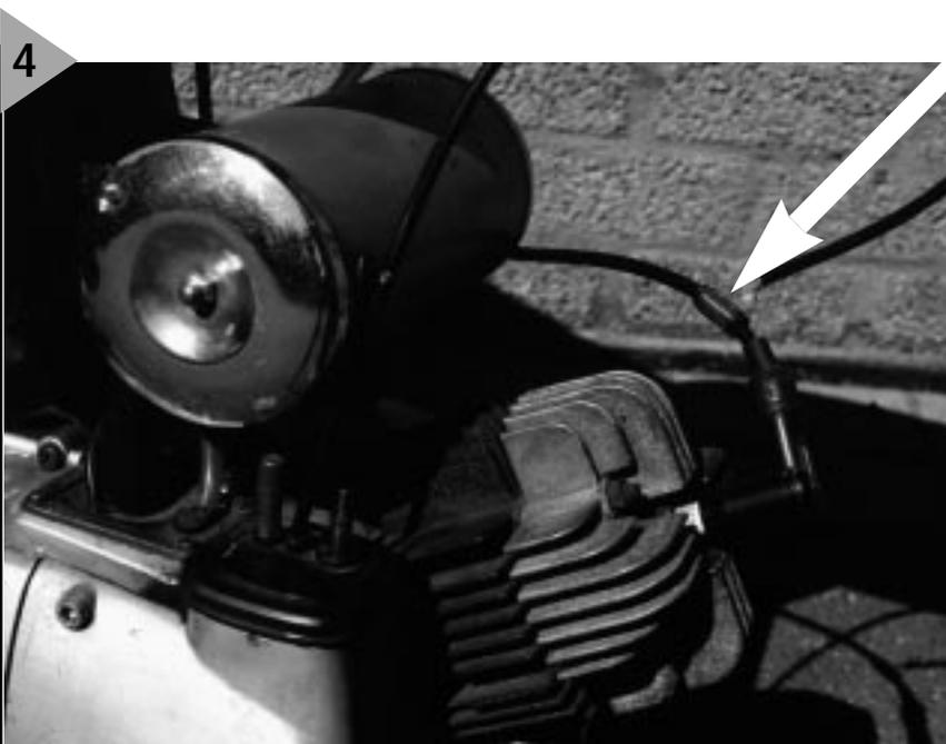
**Bild 4.** Deutlich sind die 25 Windungen der Aufnehmerspule am Zündkabel zu sehen.
