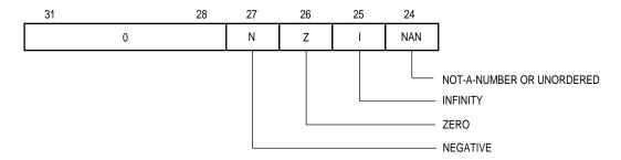
Figure 1-4. FPSR Condition Code Byte
