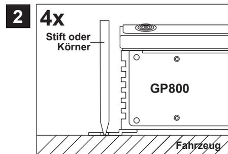
Halten Sie das GP800 an die gewünschte Einbaustelle im Fahrzeug nachdem Sie die vier Montage-Halterungen angebracht haben. Markieren Sie dann die vier Bohrlöcher mit einem geeigneten Stift oder Körner durch die Öffnungen.
