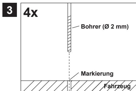
Legen Sie dann das GP800 beiseite und bohren dann die Löcher für die Fixierschrauben an den zuvor markierten Punkten.
