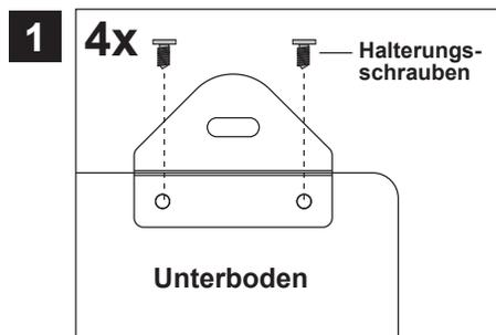
Am Unterboden des Geräts befinden sich an jeder Ecke zwei vorgebohrte Gewindelöcher. Dort müssen Sie die vier beiliegenden Montage-Halterungen mit den ebenfalls beiliegenden acht Halterungsschrauben befestigen.
