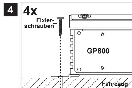
Halten Sie dann das GP800 wieder an die zuvor gewählte Position und verschrauben das Gerät mit den zuvor gebohrten Bohrlöchern am Fahrzeug.
