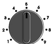
**Temperaturwahl Heizwasser.** Einstellbereich von 1-9 entspricht einer Heizwassertemperatur von 20-90°C. In Kombination mit einem digitalen Raumregler bzw. witterungsgeführten Regler wird die Einstellung am Heizwassertemperaturregler wirkungslos.
