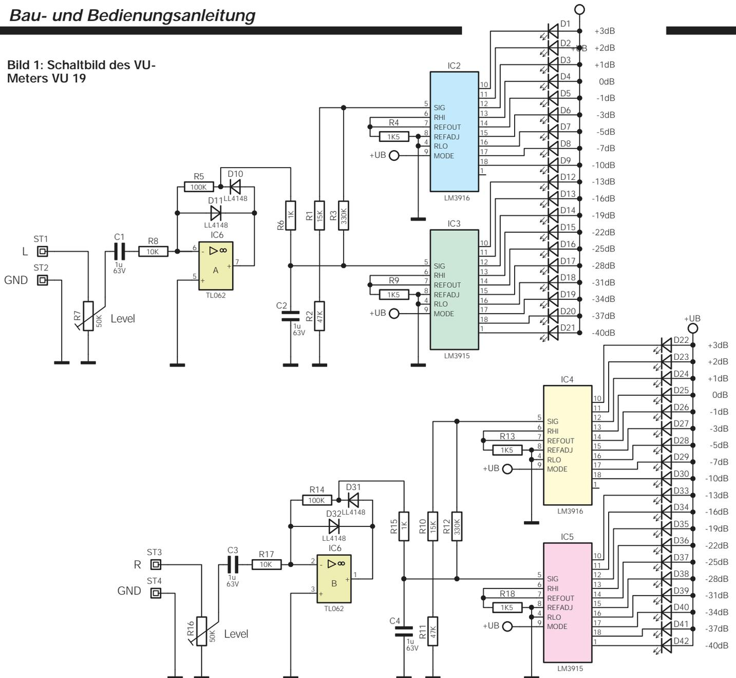
dieser Schaltung ist der für (kleine) LED-VU-Meter weite Anzeigebereich von -40 dB bis +3 dB und dessen feine Unterteilung mit 19 LEDs je Kanal. Durch den weiten Bereich bis hinab zu -40 dB werden auch sehr kleine (leise) NF-Spannungen noch angezeigt. Durch einen kleinen Schaltungstrick haben wir eine sinnvolle Unterteilung der Anzeigeaufösung erreicht: Während zwischen -40 dB und -7 dB in 3-dB-Schritten angezeigt wird, ist die Skala im kritischen Bereich um 0 dB in 1-dB-Schritten unterteilt.
