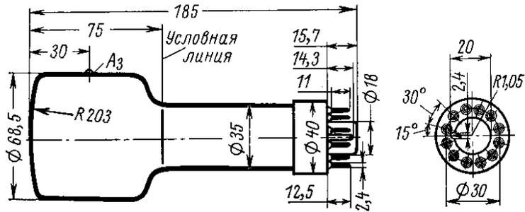
Осциллографическая трубка для визуальной регистрации электрических процессов.
