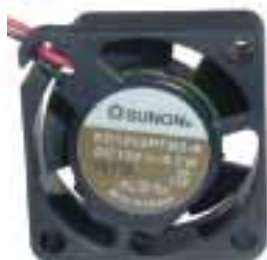
KDE1202PFB2-8 i GES 071 000 29 Vent. kuličkový SUNON 12VDC/0,7W, 10000ot, 3,4m 3 /h, 30dB, 25x25x10mm
